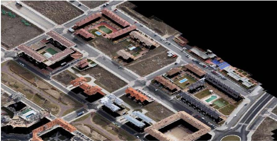
Posteriormente los datos obtenidos son procesados y cruzados para realizar el levantamiento del mapa 3D, obteniéndose así una visión completa de la zona urbana a analizar. La información que alberga este mapeado se utilizará para la elaboración de la calificación energética mediante los programas autorizados por el Instituto para la Diversificación y Ahorro de Energía (IDAE).
